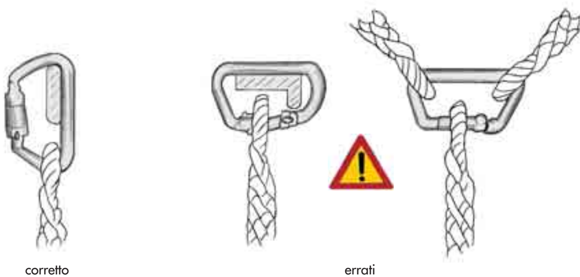
Fig. 42 - Carichi non in asse con la spina
